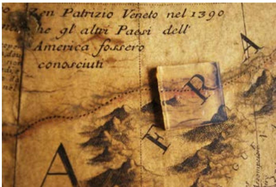
Figura 4. Gel di pHEMA/PVP durante un test applicativo per la rimozione di sporco artificiale da una stampa su carta. Si noti in particolare la trasparenza dei sistemi, che assicura un controllo totale dell'intervento di pulitura
