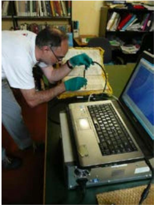
Figura 6. La strumentazione per le indagini FORS)
