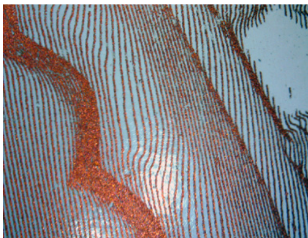
Fig. 16. Antiporta con ritratto dell'autore (v. fig. 2), da RICCIO 1855, BEUMO, A.XLII.Q.28: particolare del fregio ovale in inchiostro rosso (polvere di rame), ingrandimento a microscopio digitale.
