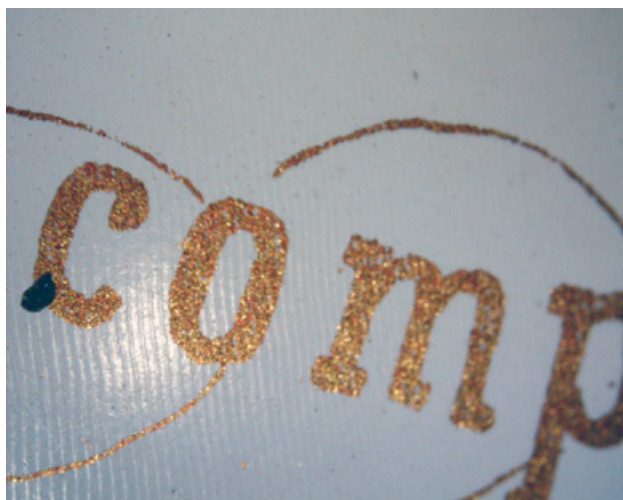
Fig. 20. Frontespizio (v. fig. 3), da RICCIO 1855, BEUMO, A.XLII.Q.28: particolare dell'indicazione dell'autore in inchiostro dorato (polvere di ottone), ingrandimento a microscopio digitale.
