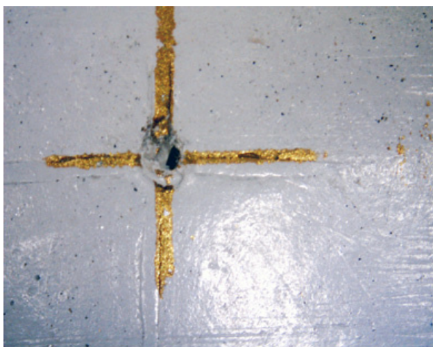
Fig. 9. Tavola V (v. fig. 6), da RICCIO 1855, BEUMO, A.XLII.Q.28: guida per centrare le tavole già dipinte nella macchina per la stampa a incavo, ingrandimento a microscopio digitale.
