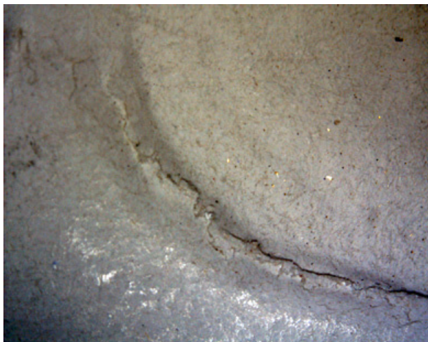
Fig. 25. Tavola I (v. fig. 4), da RICCIO 1855, BEUMO, A.XLII.Q.28: particolare del verso di una moneta che mostra il cedimento della carta causata dalla stampa a incavo, ingrandimento a microscopio digitale.
