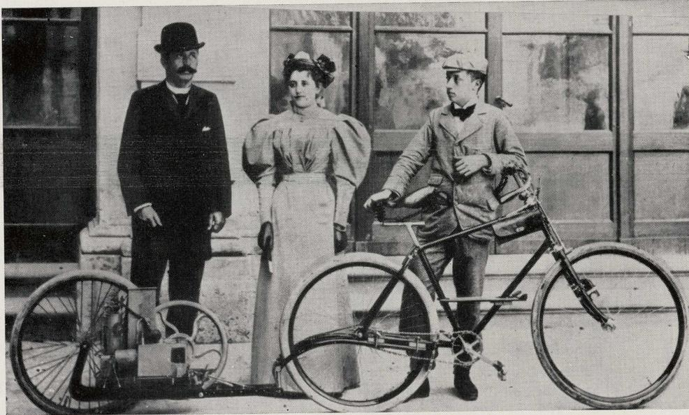
Da sinistra: Enrico Bernardi ed i figli Pia e Lauro con il primo motorscooter a benzina italiano costruito nel 1892. Il motoveicolo era a tre ruote in linea: una comune bicicletta sospinta da un motore montato su carrello posteriore monoruota.
